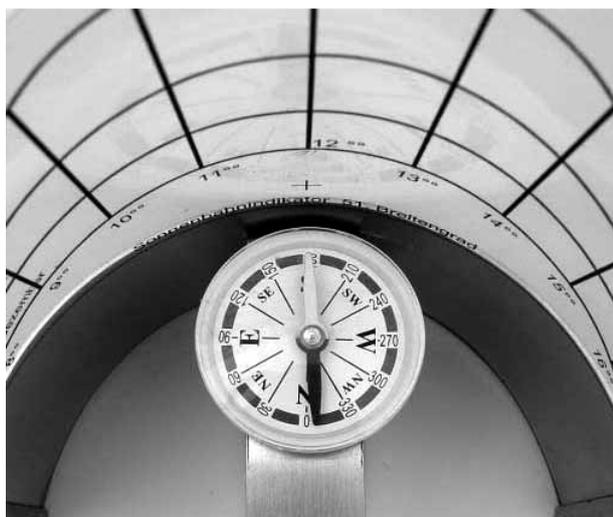
**Passo 3:** Orientare, mediante la bussola, l'analizzatore dell'orbita solare verso sud e contemporaneamente mantenerlo, possibilmente, in posizione orizzontale.
