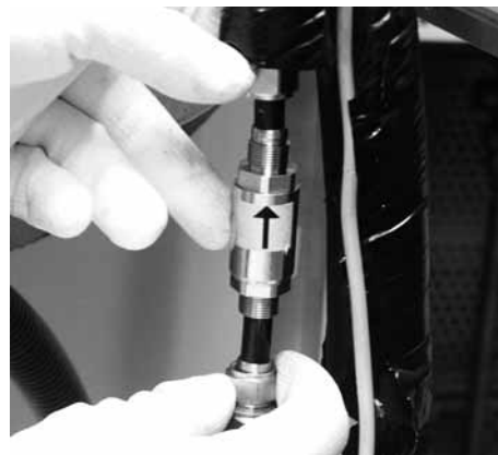
Inserimento della valvola di ritegno
