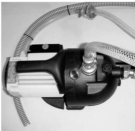
Fig. 1: Dispositivo di spurgo e di riempimento Full-Jet
