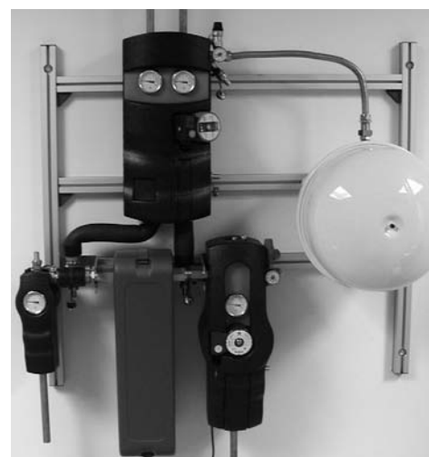
Stazione solare montata
