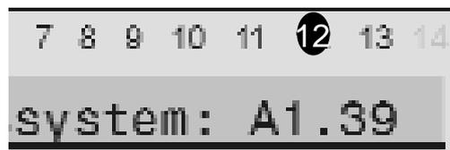
**Dettaglio del display della SolvisControl. E' evidenziata l'uscita 12 (bruciatore on). In questo modo il regolatore indica una richiesta di calore.**
