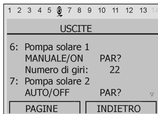
**Impostazione del livello del numero di giri premendo, girando e premendo la rotella di scorrimento con il cursore in posizione**
