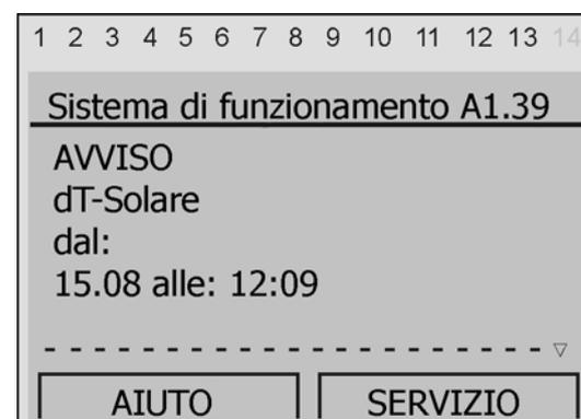
Disturbo del circuito solare (nonostante il surplus di calore non c'è circolazione nel collettore)
