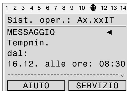
Messaggio di guasto nel sistema per acqua calda sanitaria
