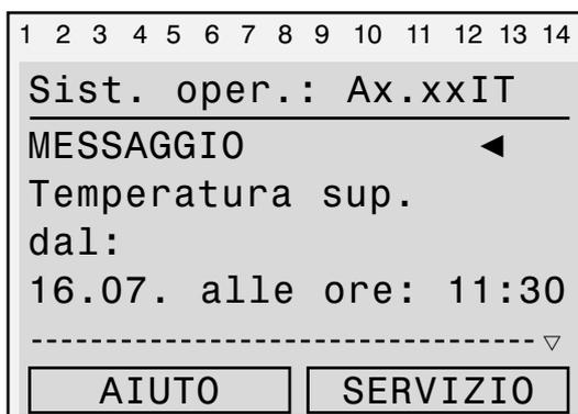
**Messaggio «Temperatura superiore» della funzione di sicurezza**
