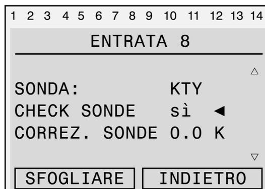
Disinserimento del controllo sensore mediante immissione «no»
