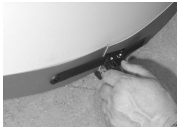
Fig. 13: Chiusura della cintura di base
