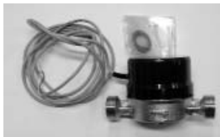
Misuratore di portata
