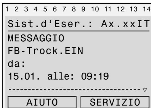
**Indicazione durante il programma di riscaldamento a secco**
