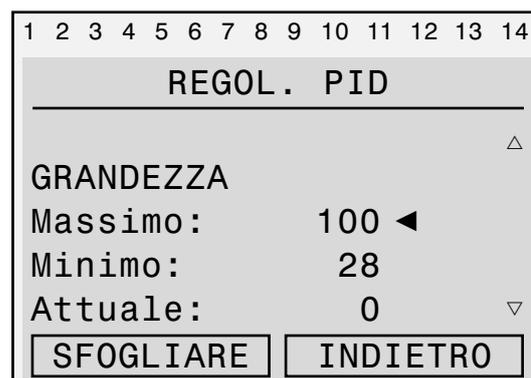
Impostazione della grandezza di comando per limitare la potenza del bruciatore per l'integrazione dell'accumulatore riscaldamento
