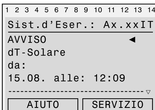
Problema nel circuito solare (nonostante l'eccesso di calore sul collettore, nessuna circolazione)
