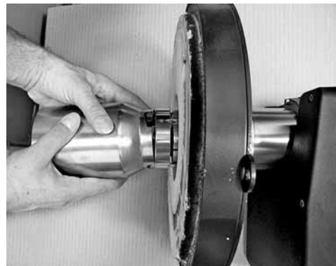
Fissare il tubo della fiamma
