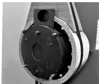
Isolamento posteriore della flangia completamente montato
