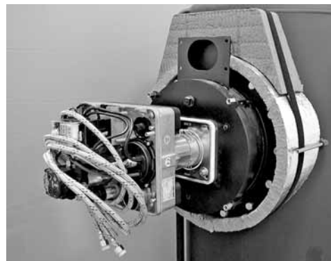
Montaggio della porta della camera di combustione
