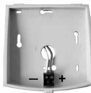
Collegamento del sensore ambientale
