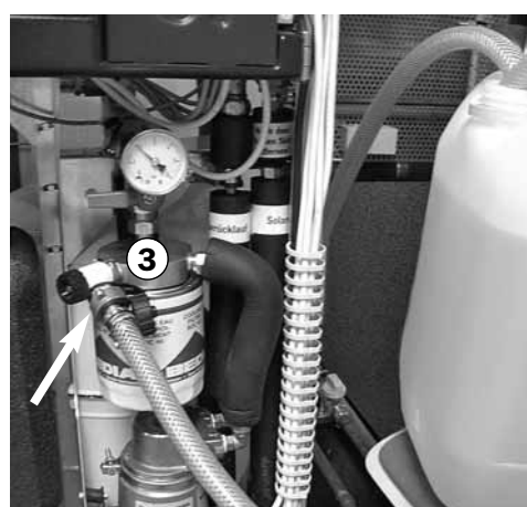
Tubo flessibile di riempimento nel rubinetto di riempimento
