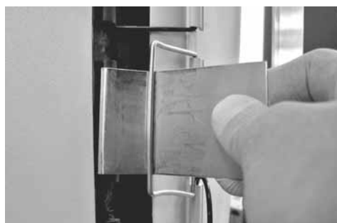
Aggancio della staffa in metallo con l'utensile di leva
