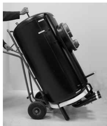
Trasporto del serbatoio con carrello
