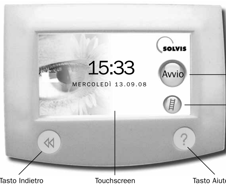
Vista del sistema di regolazione SolvisControl
