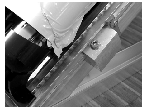
Posizionamento del dispositivo di bloccaggio destro
