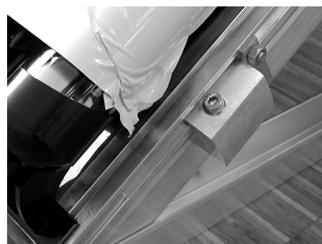
Avvitare in alto la lamiera di congiunzione
