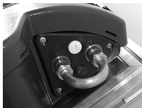
Montare l'arco di collegamento
