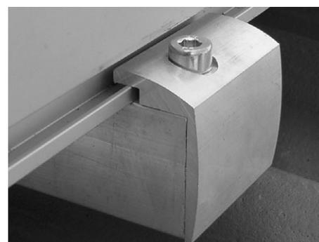
**Applicazione del dispositivo di bloccaggio al bordo destro**
