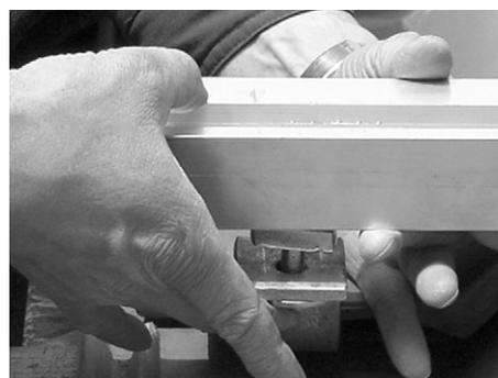
Inserire la vite con testa a martello nella traversa
