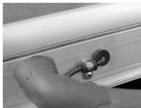
Fig. 225: Applicare la staffa per il cavo
