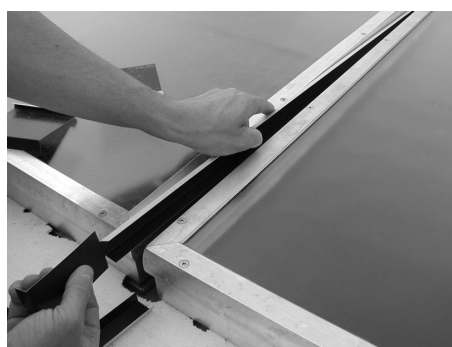
Fig. 146: Posizionare il componente centrale verticale
