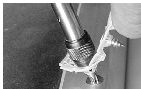
Fig. 39: Rimozione della fascetta e avvitamento della vite
