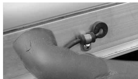
Fig. 72: Applicazione della fascetta per cavi
