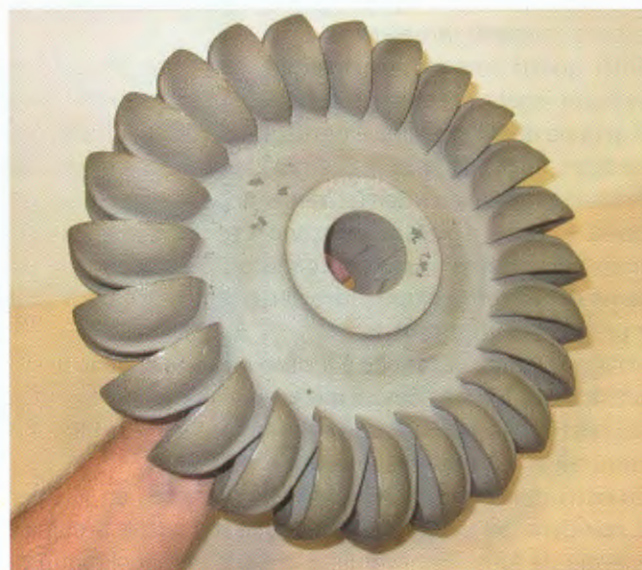
Foto 1 - Una ruota di micro turbina tipo Pelton in lega fusa in cera persa
