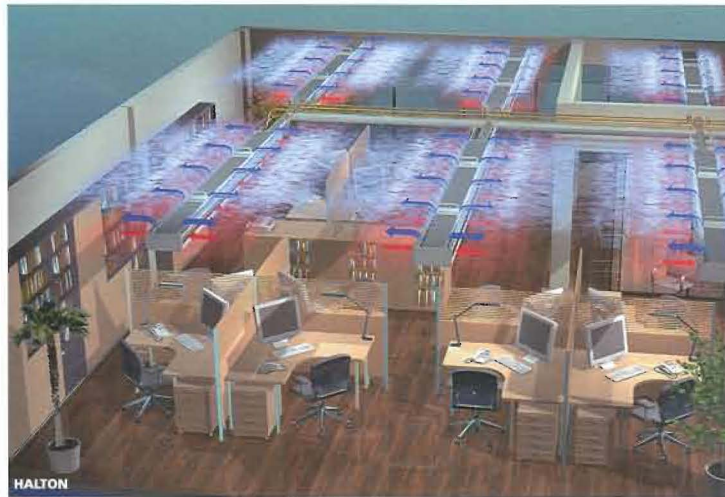
5 (a lato) Le travi fredde dotate di sistema di regolazione della portata consentono di stabilire la posizione delle sale riunioni senza alcuna limitazione. Velocità dell'aria, resa frigorifera e portata d'aria esterna possono essere regolate in modo da garantire le necessità del nuovo lay-out.
