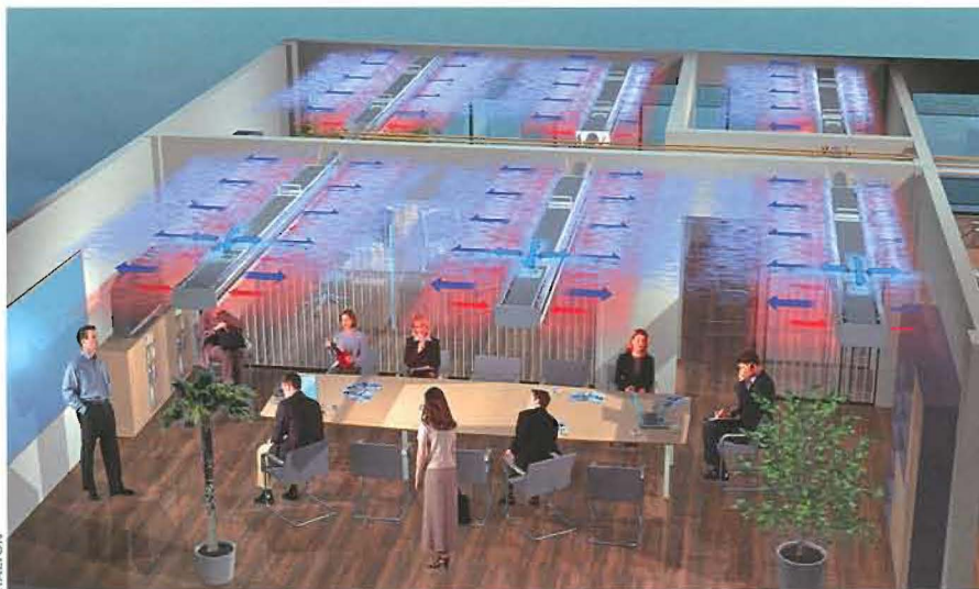
7 In caso di modifica di un ufficio in sala riunione le travi fredde possono essere ritirate per garantire valori superiori di resa e portata d'aria.
