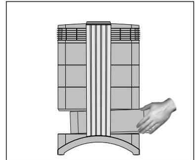
3. Posare le mani sui lati opposti del telaio 1, sollevarlo leggermente ed estrarlo lentamente. Nel momento in cui il telaio viene tolto, inclinarlo progressivamente verso l'alto per rimuoverlo completamente.
