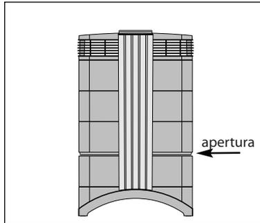
2. Con l'apertura dei bracci, la parte superiore della custodia si separa dal telaio 1, lasciando una piccola apertura.
