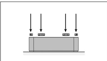
10. Accertarsi che il filtro sia completamente inserito all'interno del telaio. Inserire le graffette nelle scanalature di scorrimento all'interno del telaio e premerle verso il basso.
