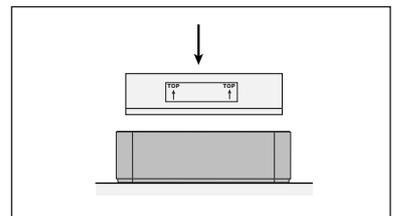
9. Capovolgere il telaio e inserire il nuovo filtro. Accertarsi che le frecce sull'etichetta del filtro siano rivolte verso l'alto.
