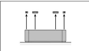
4. Rimuovere le graffette che fissano il filtro nel telaio sfilandole dalle scanalature di scorrimento.
