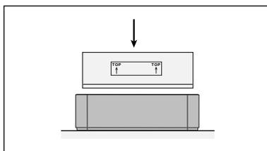
8. Capovolgere il telaio e inserire il nuovo filtro. Accertarsi che le frecce sull'etichetta del filtro siano rivolte verso l'alto.
