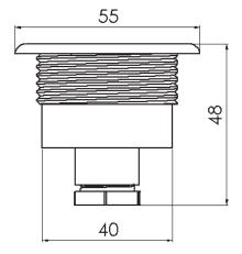
Apparecchio di illuminazione con un dispositivo cambia colore a 3 LED di potenza.
