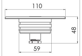
Apparecchio di illuminazione con un dispositivo cambia colore a 3 LED di potenza.
