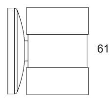
Apparecchio di illuminazione con un dispositivo cambia colore a 3 o 6 LED di potenza.
