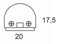
Striscia con led SMD in materiale plastico trasparente, supporto in alluminio e staffette di fissaggio.
