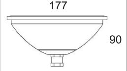
Apparecchio di illuminazione con un dispositivo cambia colore a 21 LED di potenza, per la sostituzione delle lampade PAR56.
