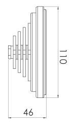
Apparecchio di illuminazione con un dispositivo cambia colore a 9 LED di potenza.
