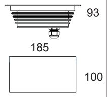
Apparecchio di illuminazione con un dispositivo cambia colore a 21 LED di potenza.
