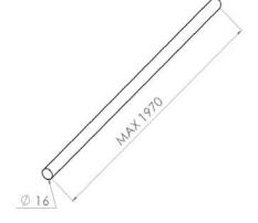
Striscia con led SMD in tubo plastico trasparente. Per uso esterno e in immersione.
