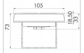
Apparecchio di illuminazione con un dispositivo cambia colore a 9 o 18 LED di potenza. Fornito con staffa di regolazione.
