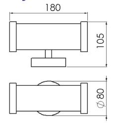
Apparecchio di illuminazione con un dispositivo cambia colore a 3 o 6 LED di potenza.
