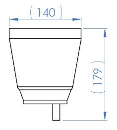
Apparecchio di illuminazione con un dispositivo cambia colore a 9 LED di potenza.
