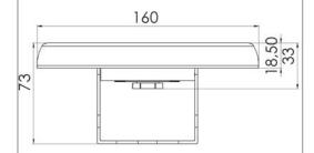
Apparecchio di illuminazione con un dispositivo cambia colore a 21 LED di potenza. Fornito con staffa di regolazione.
