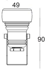
Apparecchio di illuminazione con un dispositivo cambia colore a 3 LED di potenza.
