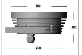
Apparecchio di illuminazione con un dispositivo cambia colore a 21 LED di potenza.
